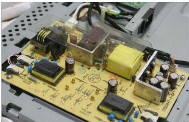
品牌机二合一高压电源板
