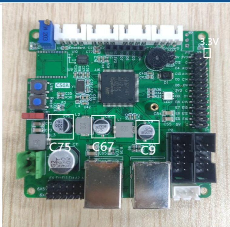
图 1-4 电解电容和排针 3.3V 图示
