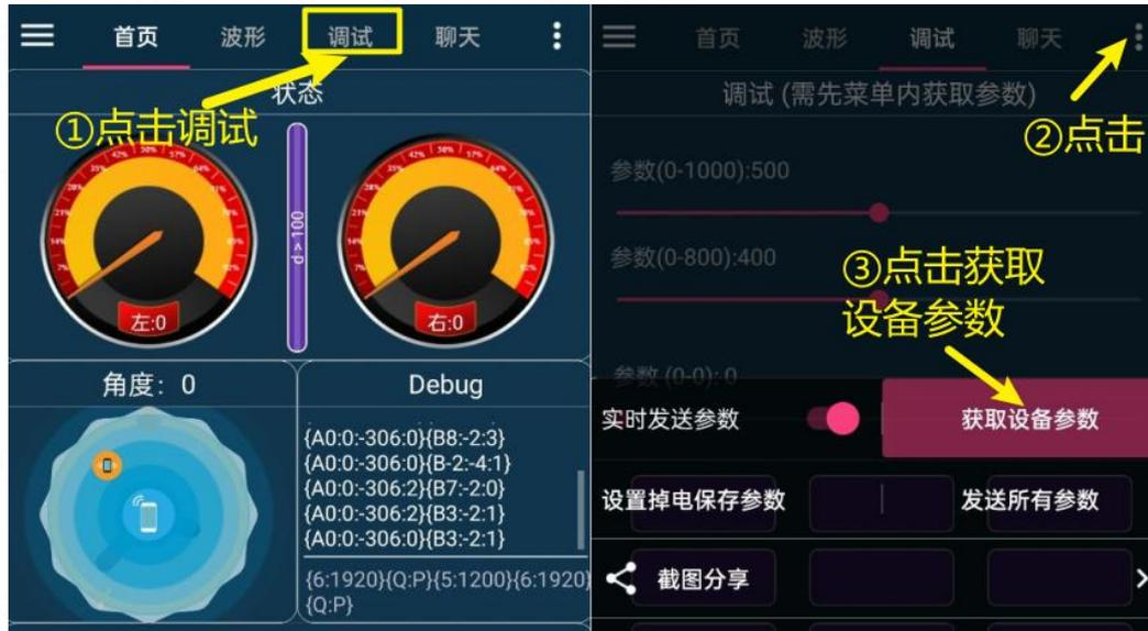
获取完设备参数后如图所示，示例中参数为 1452、1150 和 1920。每台车出厂参数不一样，在获取完参数后，请不要修改本页面的数据。（可截图保存方便以后更新）
