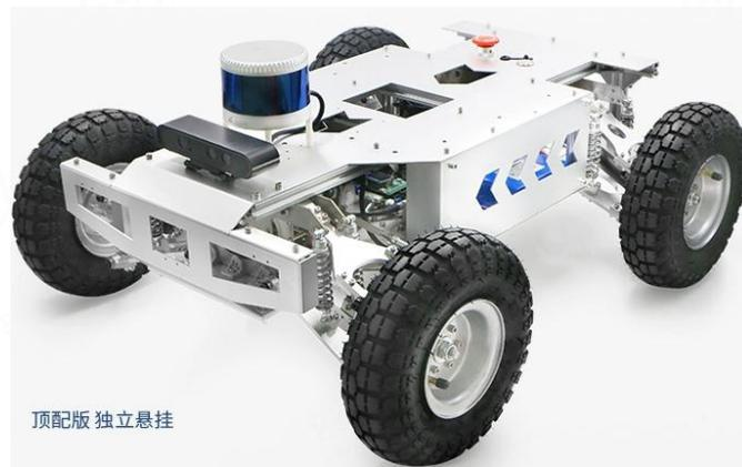
以上两款顶配阿克曼小车在出厂时，都会对舵机零点进行标定，每一辆的小车舵机零点都是不一样的，所以如果您有更新固件的需求，需要先获取出厂时舵机零点的数据再进行固件更新。如果您是其他阿克曼车型，可以忽略此说明。
