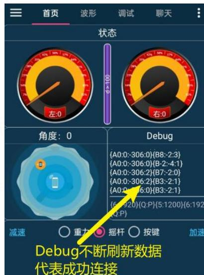
此时点击“调试”，点击右上角的“⋮”符号，点击“获取设备参数”，此时可以看到 倒数第 2、3、4 行的三个数据，这三个数据的即是出厂时舵机零点的数据，我们将其记录下来，切记此时不要手动修改里面的数据。
