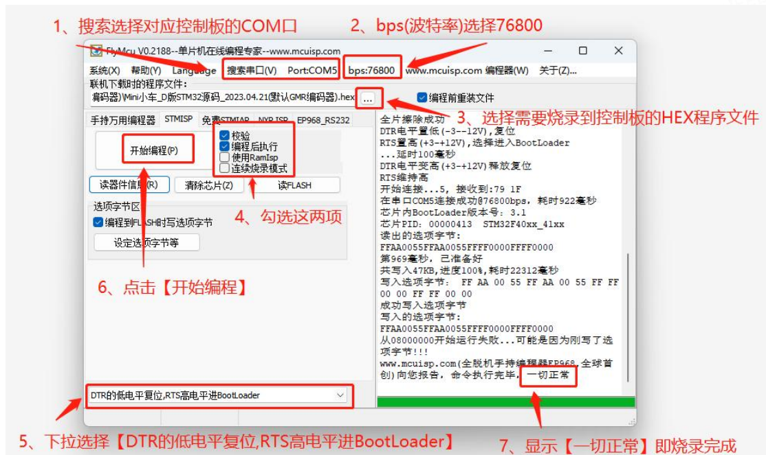
图 8-3 FlyMcu 下载程序配置说明
