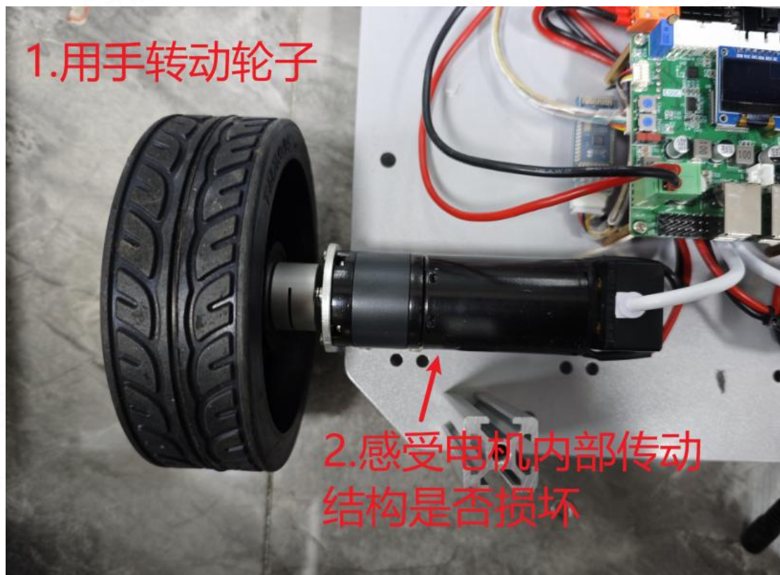
图 2-2 电机硬件问题排查图
