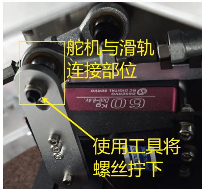
图 4-4 顶配阿克曼舵机与滑轨的连接图
