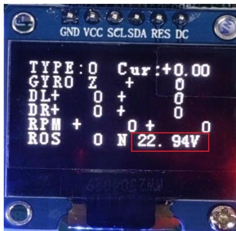
图 3-7 电压 OLED 显示
