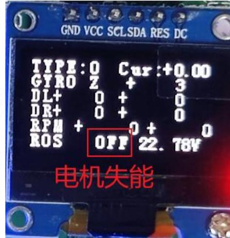
图 3-6 电机失能 OLED 显示
