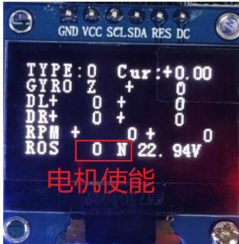
图 3-5 电机使能 OLED 显示
