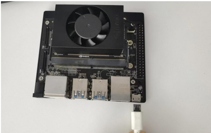
图 1-9 Jetson NX 的 OTG 口与电脑 USB 口相连
