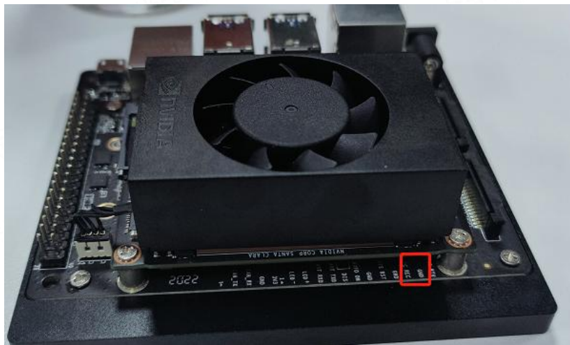
图 1-6 短接 REC 与 GND
