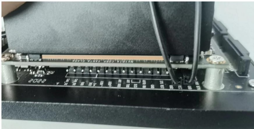
图 1-8 短接 REC 与 GND 引脚
