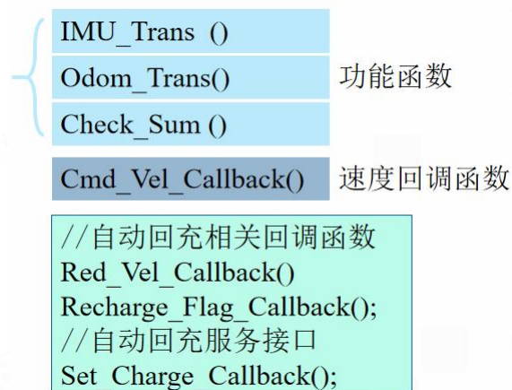
图 1-6-2 wheeltec_robot.cpp 代码结构
