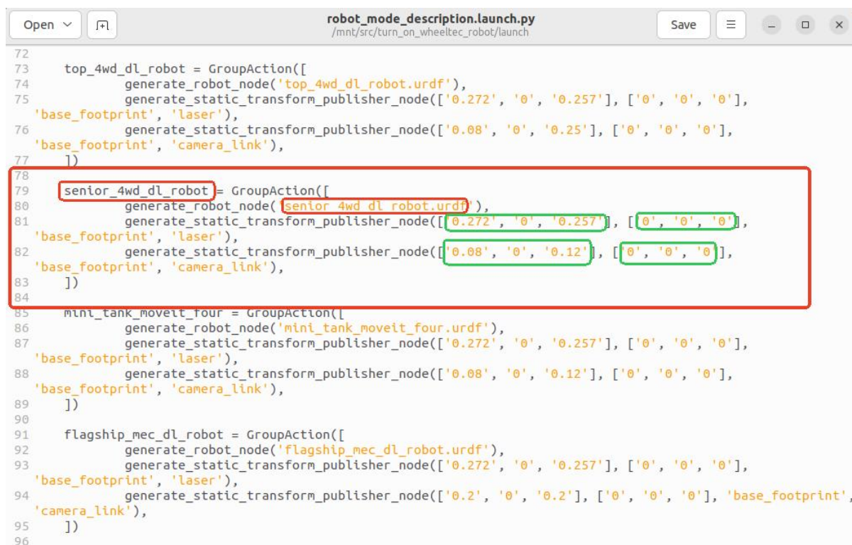
图 2-11 根据车型需要，添加相对应车型的格式代码
