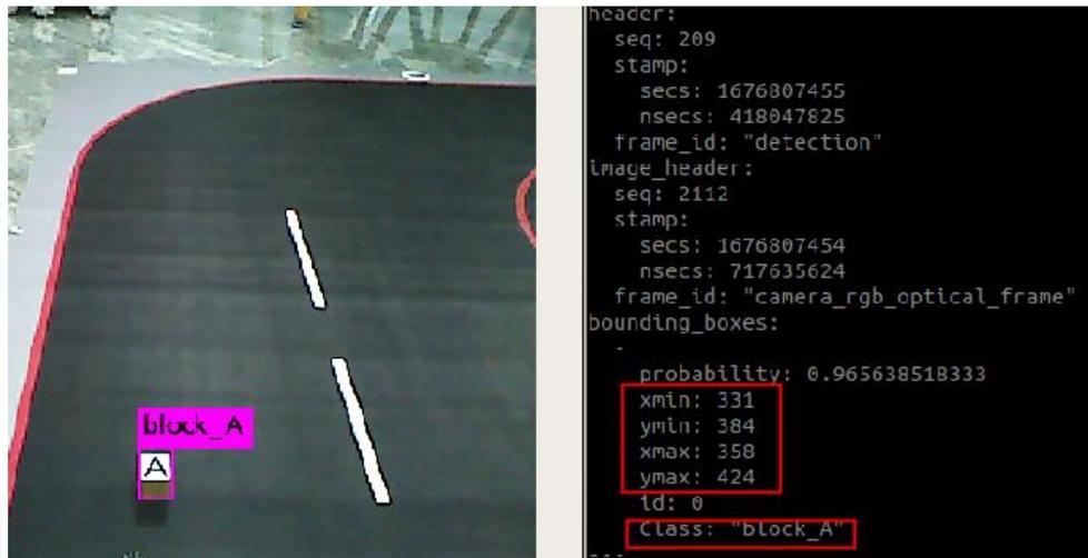
查看echo话题的终端 确认此时yolo获取到的识别框的四个端点坐标 如下左图红框
