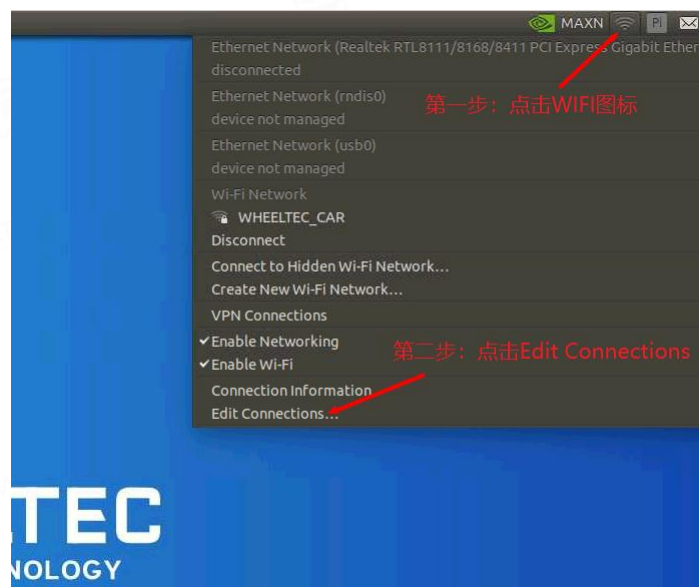
图 2-2-1 Jetson nano 连接 wifi 步骤（一、二）
