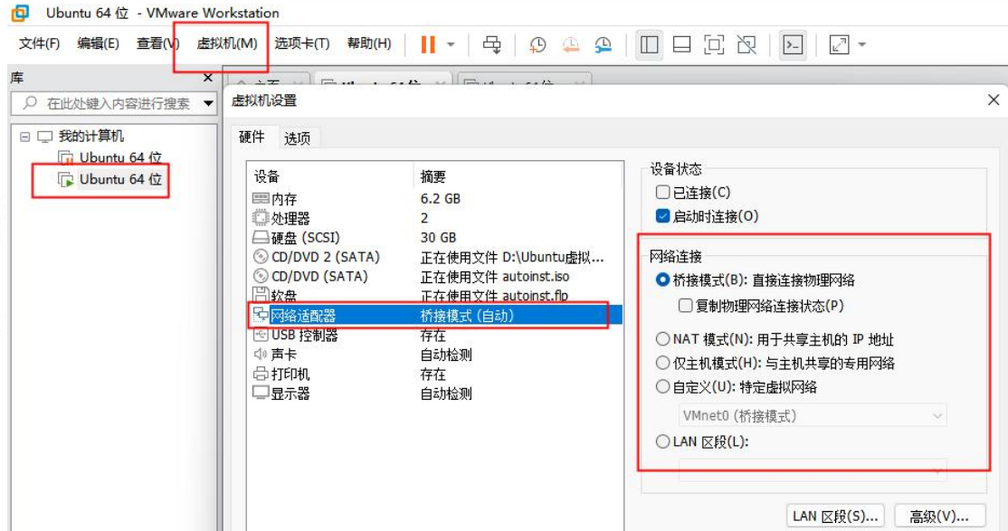
图 1-1 虚拟机（镜像）如何切换网络连接模式
