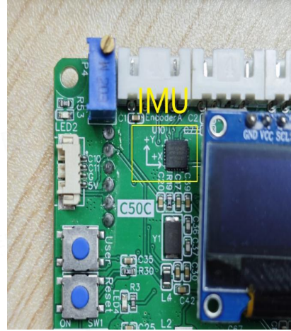
图 1-3 ROS 大型科研机器人上的 IMU 位置
