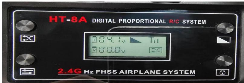
图 3-3 关闭混控后的显示屏信息
